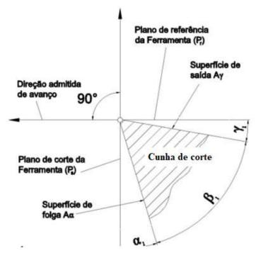
**Figura 2.8**: Ângulos de uma ferramenta de corte. Fonte: FREITAS JUNIOR (2018)
