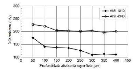
**Figura 2.19**: Perfis de microdureza após fresamento de aço AISI 1010 e AISI 4340,  $v_c$ = 100 m/min,  $f_z$ = 0,05 mm/dente e  $a_p$ = 0,5 mm. Sem fluido de corte. Fonte: PEREIRA *et al.* (2017) modificado.
