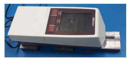
Figura 3.8: Rugosímetro portátil Mitutoyo
