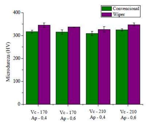
**Figura 2.21**: Relação da microdureza com o tipo de pastilha. Fonte: FREITAS JUNIOR (2018)
