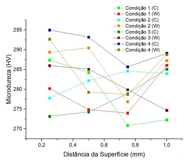
**Figura 4.7**: Microdureza apresentada por distância da borda para cada condição e tipo de pastilha utilizada.
