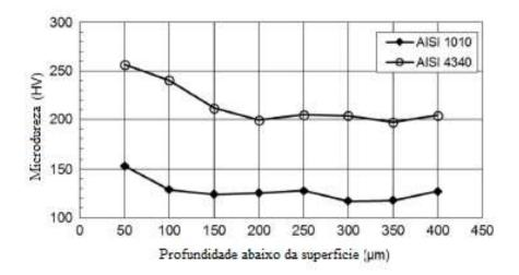
**Figura 2.20**: Perfis de microdureza após fresamento de aço AISI 1010 e AISI 4340,  $v_c$ = 300 m/min,  $f_z$ = 0,05 mm/dente e  $a_p$  = 0,5 mm. Sem fluido de corte. Fonte: PEREIRA *et al.* (2017) modificado.
