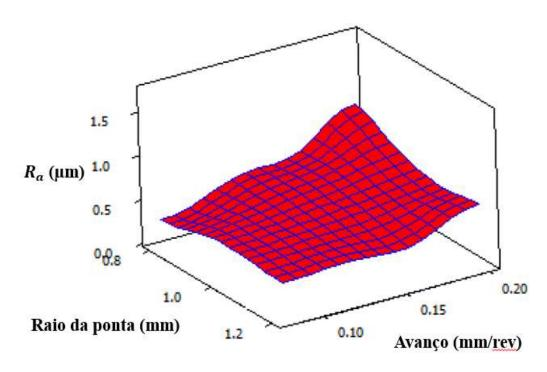
**Figura 2.17**: Influência do raio da ferramenta e do avanço na rugosidade da peça usinada. Fonte: D'ADDONA & RAYKAR (2016) modificado
