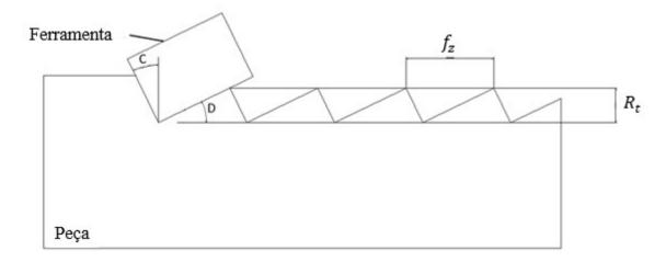
**Figura 2.15**: Perfil de corte no fresamento de topo Fonte: MACHADO *et al.* (2009) modificado
