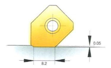
**Figura 2.13**: Comprimento  $b_s$  da pastilha *wiper* e seu ajuste. Fonte: SANDVICK (2005)
