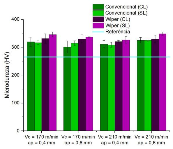
**Figura 4.6**: Comparação da microdureza gerada no fresamento com lubri-refrigeração (CL) e sem lubri-refrigeração (SL).
