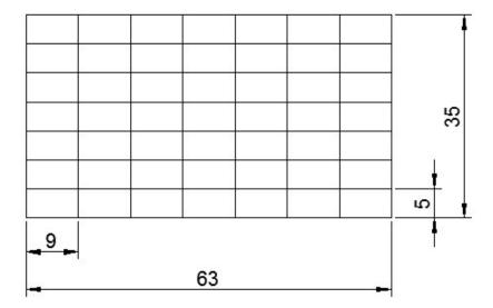
Figura 3.9: Dimensões da malha desenhada sobre a superfície da amostra (unidades em mm)
