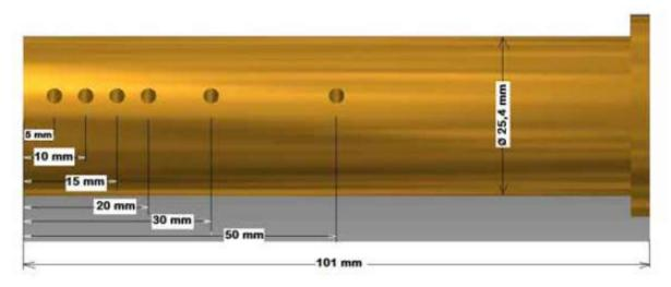
**Figura 2.22**: Corpo de prova e posicionamento dos termopares. Fonte: XAVIER *et al.* (2014)
