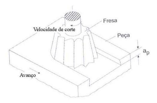
**Figura 2.4**: Parâmetros de corte no fresamento de topo. Fonte: DINIZ *et al.* (2013) modificado
