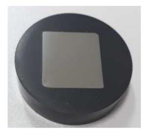
Figura 3.12: Amostra pronta para o ensaio de microdureza em profundidade
