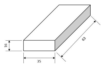
Figura 3.3: Dimensões finais obtidas para a amostra (unidades em mm).
