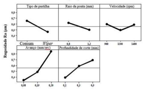
**Figura 2.16**: Comparação dos principais parâmetros de corte analisados pela rugosidade gerada.
