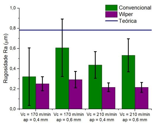
**Figura 4.3**: Média dos valores de rugosidade  $R_a$  por condição de corte e pastilha utilizada.
