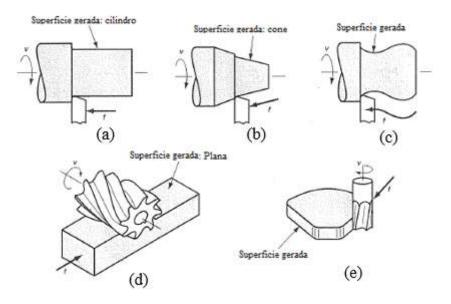
**Figura 2.1**: Tipos de superfícies geradas por usinagem Fonte: GROOVER (2010) modificado.
