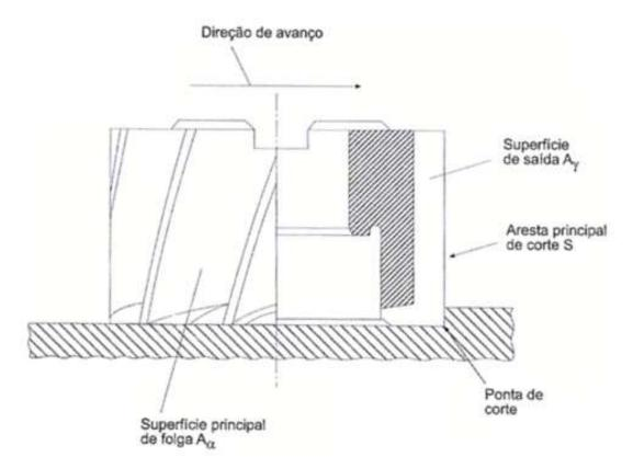
**Figura 2.9**: Arestas de corte e superfícies da parte de corte de uma fresa de topo. Fonte: DINIZ *et al.* (2013)
