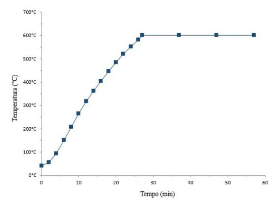
Figura 3.4: Curva de estabilização de temperatura do forno durante o TTAT
