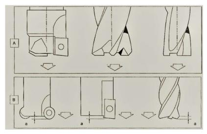
**Figura 2.6**: Fresas de topo para usinagens de bolsões Fonte: DINIZ *et al.* (2013)
