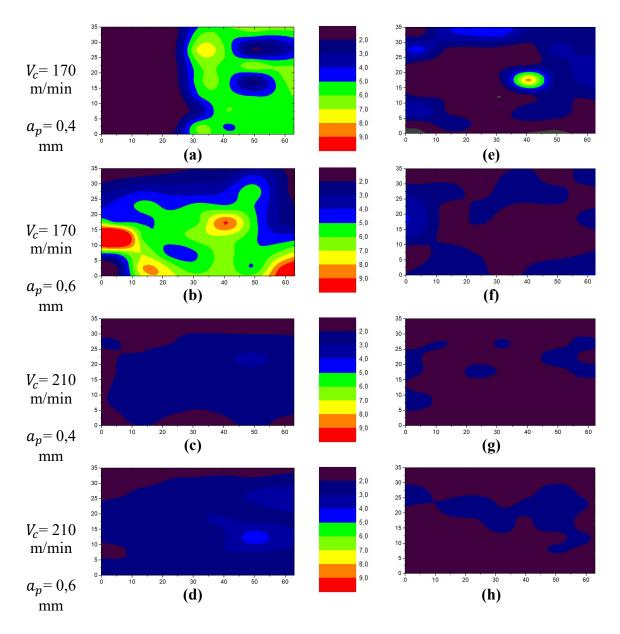
**Figura 4.2**: Rugosidade Rt das superfícies usinadas: (a) C1, (b) C2, (c) C3, (d) C4, (e) W1, (f) W3, (g) W5, e (h) W7
