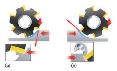
**Figura 2.5**: a) Fresamento tangencial concordante. b) Fresamento tangencial discordante. Fonte: SANDVIK (2018) modificado
