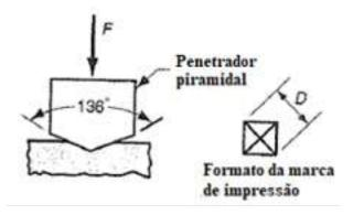
**Figura 2.18**: Ensaio de dureza Vickers Fonte: GROOVER (2010) modificado
