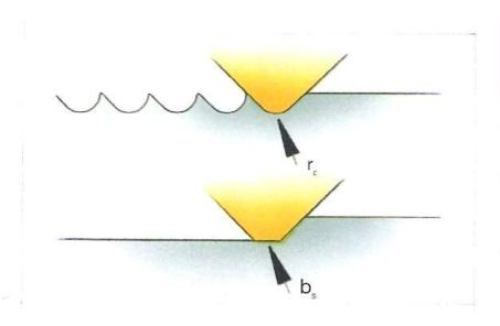
**Figura 2.12**: Comparação da superfície gerada por pastilha com raio de ponta e pastilha com fase plana como aresta secundária.
