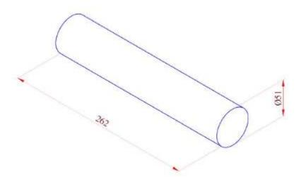
Figura 3.1: Barra de aço SAE 4340 de secção circular fornecida com sua geometria inicial (unidades em mm)
