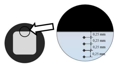
Figura 3.13: Posicionamento das indentações no ensaio de Microdureza em profundidade.
