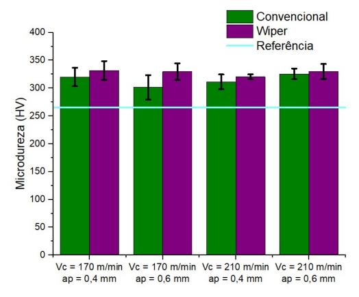
Figura 4.5: Média dos valores de microdureza para cada condição e pastilha utilizada
