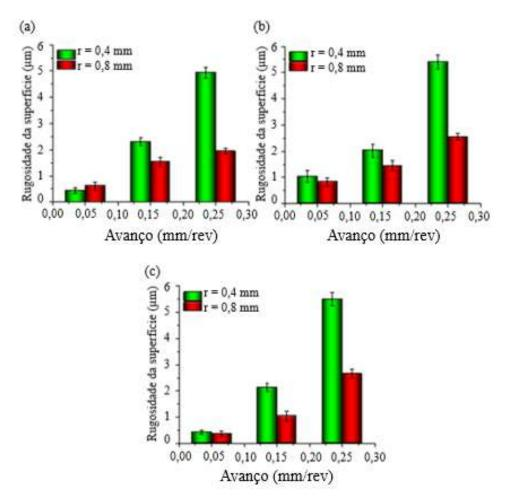
**Figura 2.10**: Efeito do raio da ferramenta na rugosidade superficial da peça usinada em diferentes velocidades de corte - a) 80 m/min b) 100 m/min c) 120 m/min. Fonte: HUA & LIU (2018) modificado
