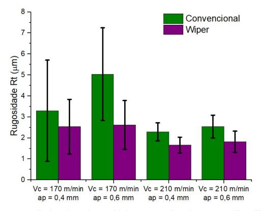
**Figura 4.4**: Média dos valores de rugosidade  $R_t$  por condição de corte e pastilha utilizada.
