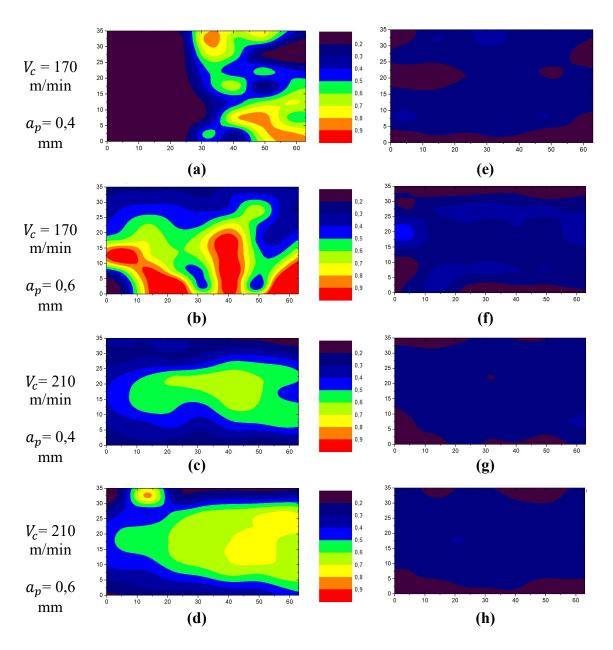
**Figura 4.1**: Rugosidade Ra das superfícies usinadas: (a) C1, (b) C2, (c) C3, (d) C4, (e) W1, (f) W3, (g) W5 e (h) W7
